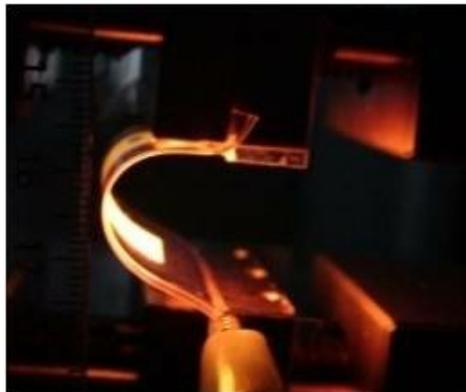
**Contrairement à la technique à base d'oxyde d'indium-étain qui est encore couramment utilisée, ces électrodes transparentes offrent une plus grande flexibilité. Elles ont également l'avantage de pouvoir être fabriquées sur une grande surface par impression sur un substrat flexible de type polyéthylène téréphtalate. © Laboratoire de chimie des polymères organiques, Fraunhofer Comedd**
